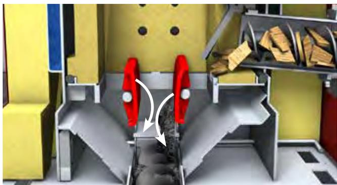
Alla partenza con caldaia fredda avviene una pulizia completa della camera di combustione. Entrambe le griglie si aprono, la cenere cade e si riducono le croste e i corpi estranei come pietre, chiodi, ecc.
