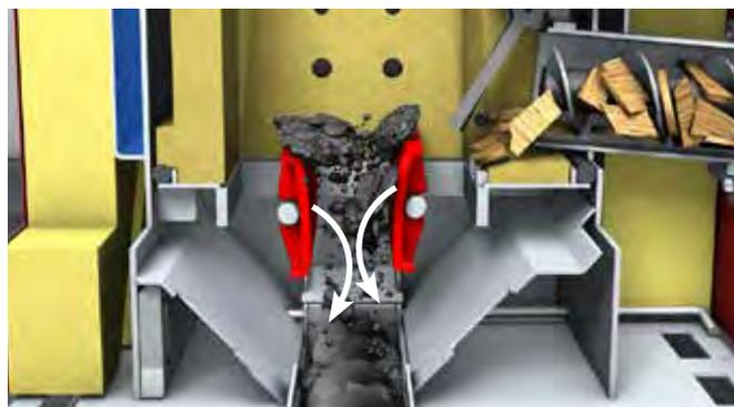
In caso di combustione di erbe energetiche come miscanthus, ecc. la griglia-double-rotary rimuove le croste e pulisce il braciere totalmente.
