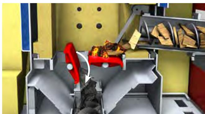
Quando si utilizza pellet come combustibile durante il processo di pulizia si apre solo una griglia rotante. La cenere cade, la brace rimane.
