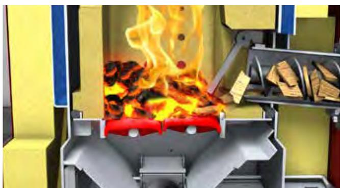
Durante la combustione, le griglie possono essere spostate selettivamente in modo da mantenere il letto di brace omogeneo.
