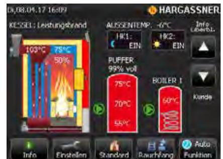
**Caldaia in funzionamento a carico parziale:**
