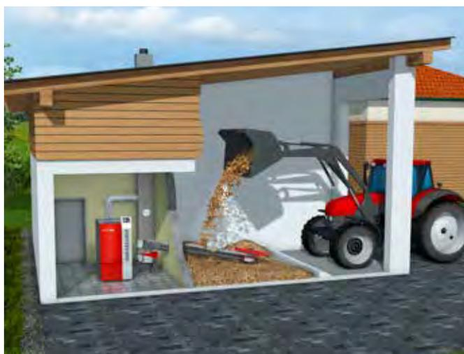
**Locale caldaia e locale di deposito nell'edificio adiacente o in un edificio caldaia a livello del suolo**
