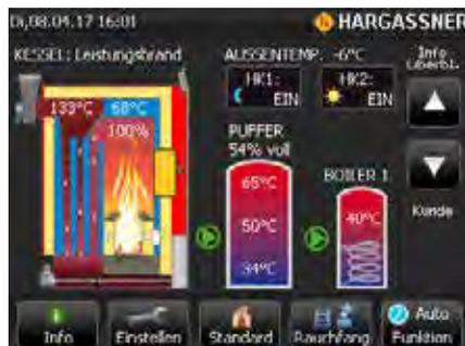
**Caldaia in funzionamento a pieno carico:**
