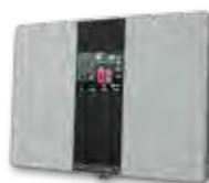
**Regolatore circuito HKR con touch:** Regolatore circuito con regolazione climatica dalla temperatura esterna e l'unità di comando. È possibile collegare fino a 2 circuiti miscelati e 1 circuito bollitore con pompa circolazione; un accumulo cioè una caldaia di teleriscaldamento, una pompa d'accumulo cioè di teleriscaldamento, un circuito esterno (mass. 16 HKR). SD-Slot e memorizzazione dei dati.
