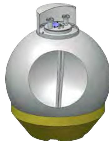
Un'altra soluzione di deposito è il serbatoio interrato sferico resistente alla corrosione, in fibra di vetro rinforzata con resina poliesteri GFK. Non sono necessarie armature in acciaio o cemento armato. Garantisce la sicurezza massima tramite un pacchetto speciale con la protezione esplosione per il serbatoio. Questo sistema Hargassner è composto da un corpo base con tutti gli allacciamenti necessari per il caricamento, come anche gli allacciamenti per tubo aspirazione e tubo aria di ritorno.
